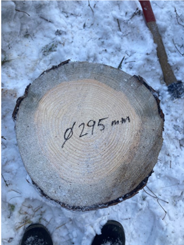
Figur 1. Tvärsnitt från träd (Fjällnora I) med spår efter valsar/knivar där all bark har lossnat i form av små barkbitar.
